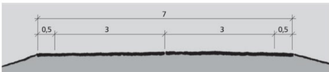
Figur 8: Tverrprofil A2, 7 m vegbreidde (mål i m).
